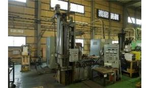
コイルによる高周波電流の誘導加熱を利用して、部品の表面のみを焼入れする加工法が、高周波焼入です。必要な箇所への焼入れを短時間で行うことができ、焼入れ深さの調節も自在に行えます。
