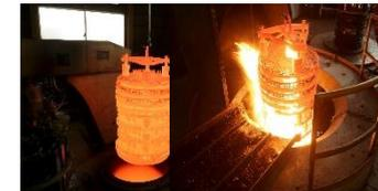
鋼の結晶粒を微細化し、機械的性質を高める焼ならしや、鋼の軟化、内部応力の除去などを目的とする焼なまし、そして、長物の焼入、焼戻に対応しています。
