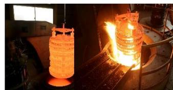
鋼の結晶粒を微細化し、機械的性質を高める焼ならしや、鋼の軟化、内部応力の除去などを目的とする焼なまし、そして、長物の焼入、焼戻に対応しています。
