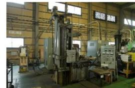
コイルによる高周波電流の誘導加熱を利用して、部品の表面のみを焼入れする加工法が、高周波焼入です。必要な箇所への焼入れを短時間で行うことができ、焼入れ深さの調節も自在に行えます。
